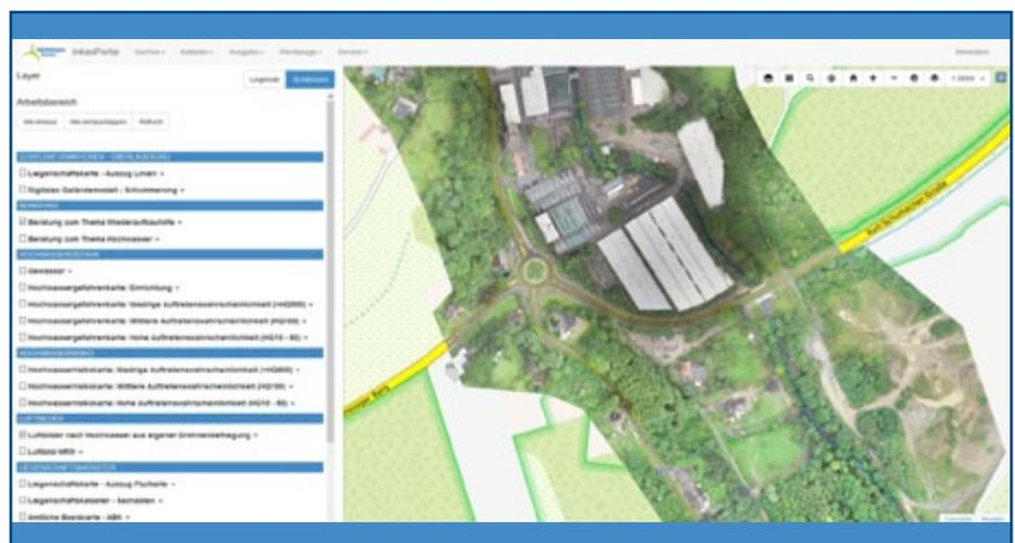
Ergebnis der Erhebung aus der Luft durch das Kataster- und Vermessungsamt entlang der Vicht (Bodenauflösung rund 2,5 cm) und Darstellung im Geoportal.
