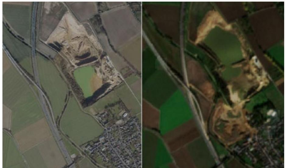
Die Abbildung zeigt die unterschiedliche Qualität der Geodaten am Beispiel der in Folge der Flutkatastrophe im Juli 2021 überfluteten Kiesgrube in Erftstadt-Blessem. Die reduzierte Auflösung der Satellitendaten fällt sofort ins Auge, tritt aber im Interesse der Aktualität – gerade bei flächenhaften Informationen – in den Hintergrund.
