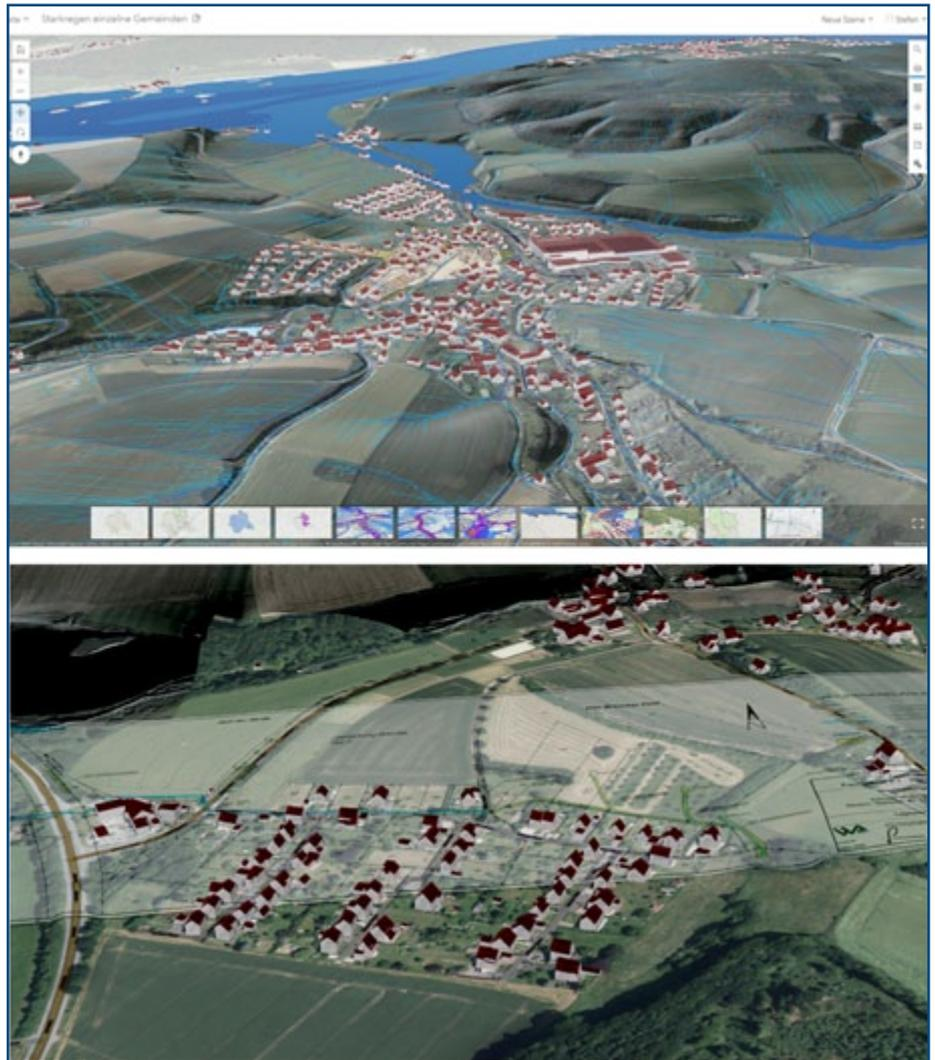
Interaktive Hochwasser- und Starkregengefahrenkarte mit gemeinsamer Darstellung von Hochwasser- und Starkregenszenarien (oben) sowie integriertem pdf-Plan – Hochwasserschutz (unten).
