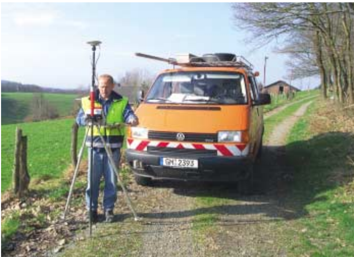
Vermessungsingenieur Wolfgang Baumert vom Vermessungs- und Katasteramt des Oberbergischen Kreises bei der Satellitenvermessung
