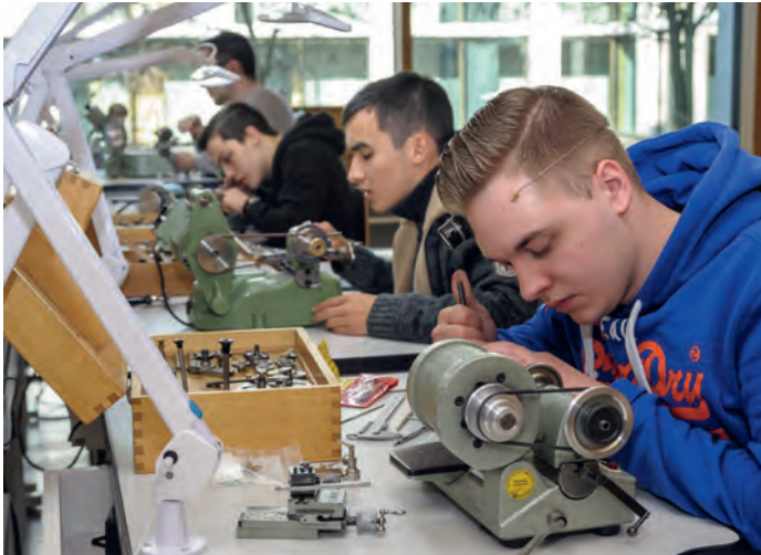
Feinmechanikerarbeiten bei der Herstellung von Uhrwerken.
