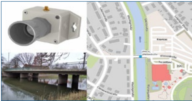
Abb.: Sensortechnik LoRaWAN für Hochwasserschutz (Kreise Herford und Lippe)
