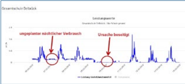
Abb.: Unstimmigkeiten bei Wasserverbrauchsmessung (Stadt Delbrück) [41]
